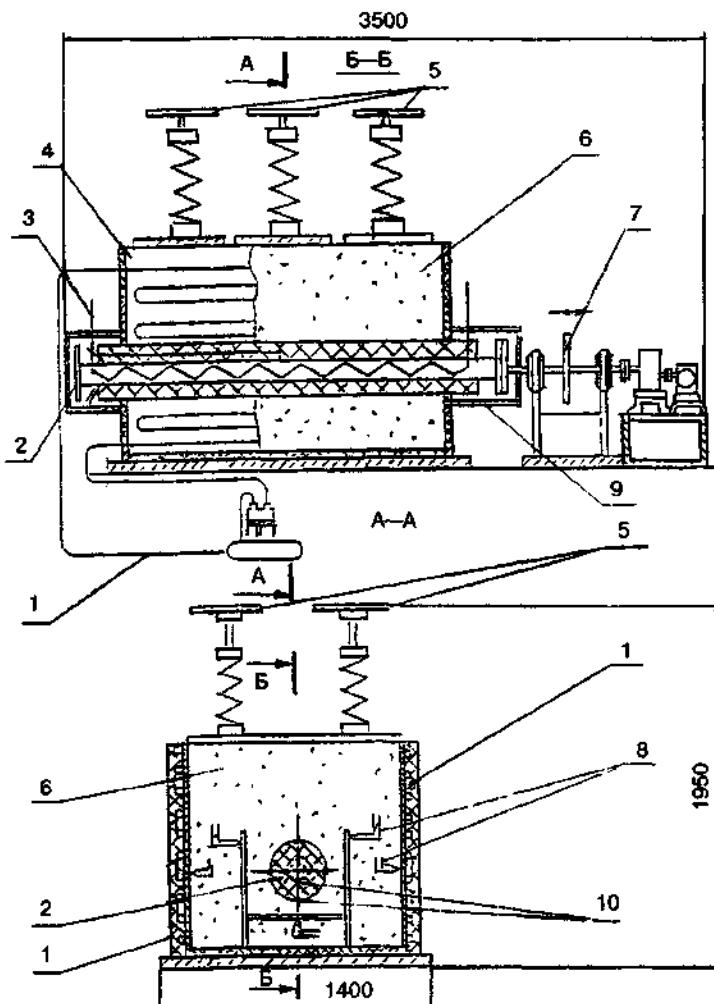
1 — система охлаждения, 2 — фрагмент теплопровода, 3 — нагреватель, 4 — камера, 5 — нажимное устройство, 6 — грунт; 7 — механизм протяжки, 8 — размещение термопар в камере стенда, 9 — теплоизоляция концевых участков, 10 — размещение термопар на фрагменте теплопроводов
